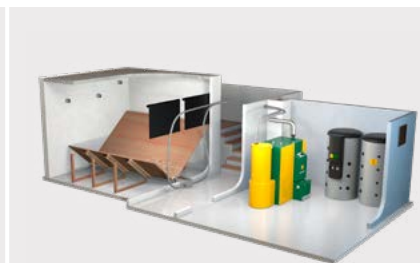
Förder Schnecke mit Saugförderung
