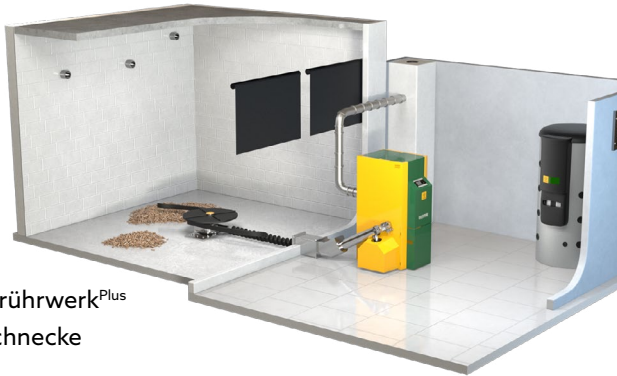
Trockener Lagerraum direkt neben Heizraum
